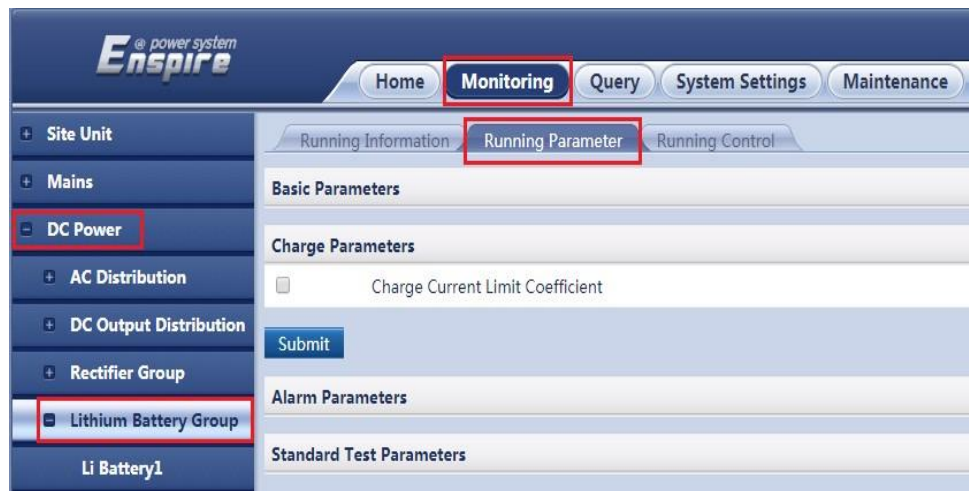
Figura 4-16 Configuración del coeficiente límite de corriente de carga
