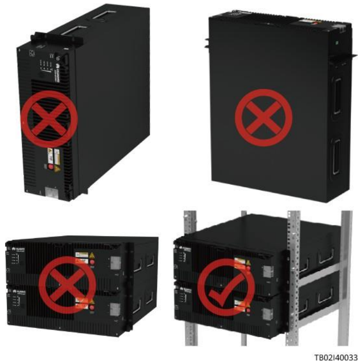
Figura 4-2 Diagrama de instalación correcto
