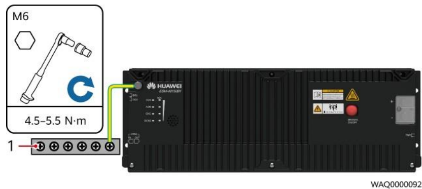
Figura 4-3 Instalación del cable de tierra ESM
