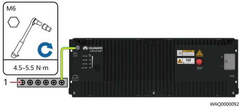
Figura 4-10 Instalación del cable de tierra ESM
